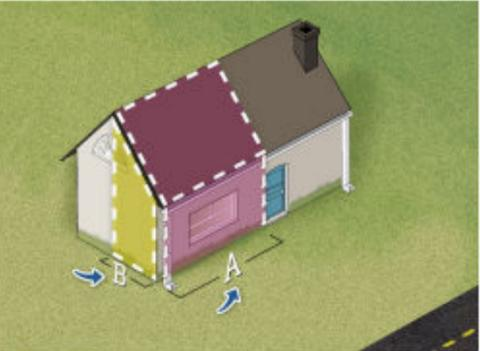
Rappel : la longueur (A) et la largeur (B) sont mesurées au niveau du sol.
